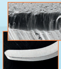
Borde de corte de una cureta sin revestimiento típica y ampliación del borde tras la prueba.
